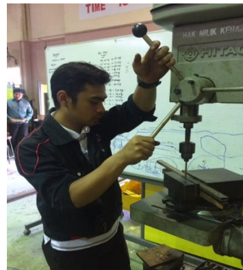
Rajah 3.7 (ii) Proses membuat lubang menggunakan mesin bench drill
