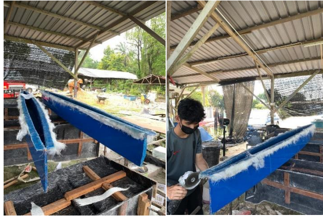
Rajah 3.16: Hasil fiberglass yang telah siap
