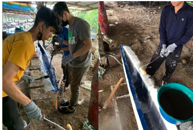
Rajah 3.12: Proses menampal dan membuang angin pada fiberglass
