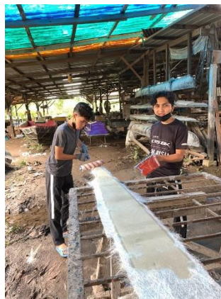
Rajah 3.14 : Melekatkan gam pada fiberglass
