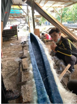
Rajah 3.13: Menunggu fiberglass sehingga kering
