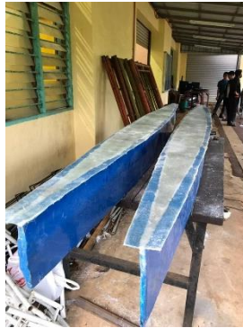
Rajah 3.19: Hasil pelampung yang diperbuat daripada fiberglass
