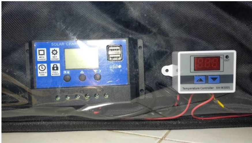
Rajah 3.9 Melekatkan sensor pengawal suhu dan solar charge controller
