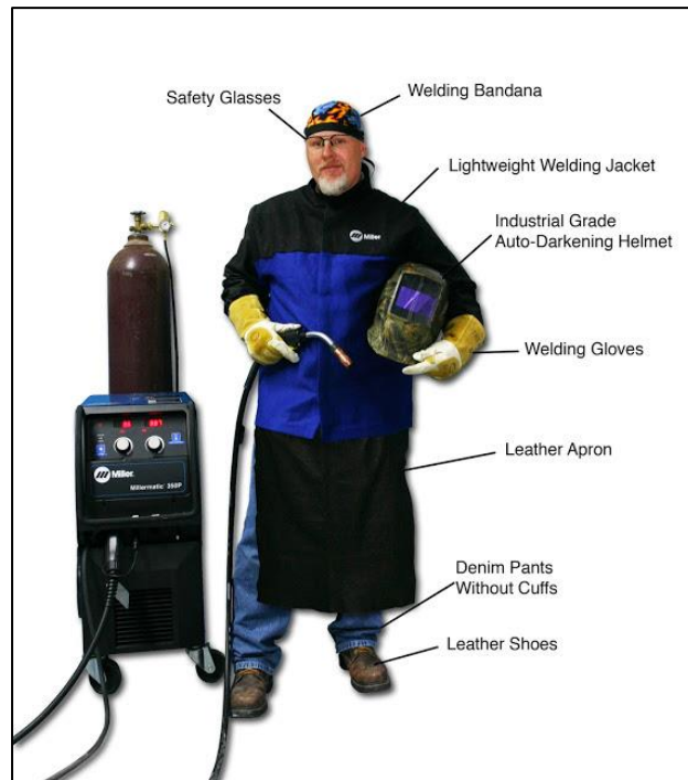
Rajah 2.15 : menunjukkan cara pemaikaian yang selamat semasa proses kimpalan
