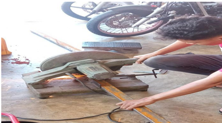
Rajah 3.8: Proses pemotongan besi menggunakan grinder .
