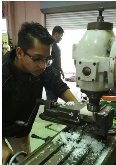
Rajah 3.11 Menggunakan mesin milling
