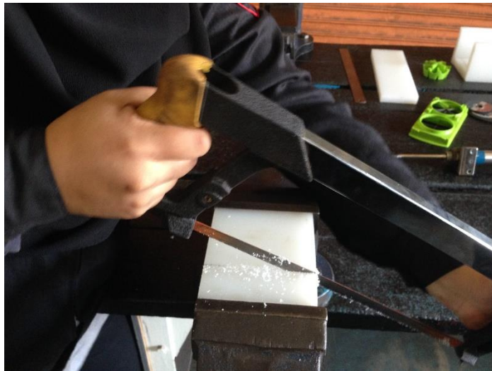
Rajah 3.8 Memotong polyethelyne menggunakan gergaji
