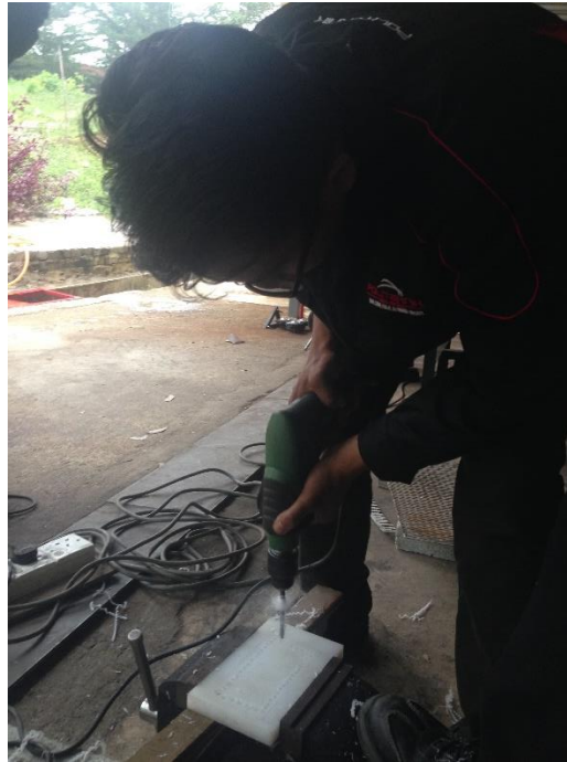
Rajah 3.10 Menebuk lubang menggunakan gerudi
