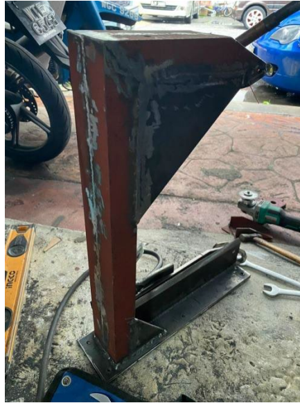
Rajah 3.8 Proses mencanai untuk kemasan
